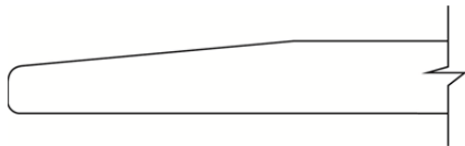
REB: Borde longitudinal rebajado
