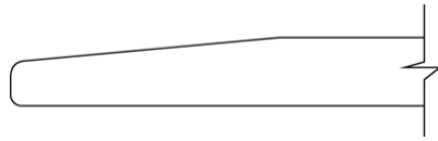
REB: Borde longitudinal rebajado
